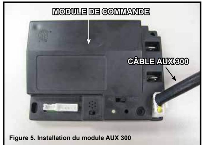
Figure 5. Installation du module AUX 300
