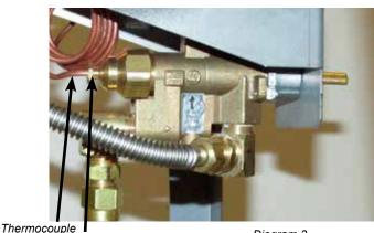
Loosen nut Diagram 3
