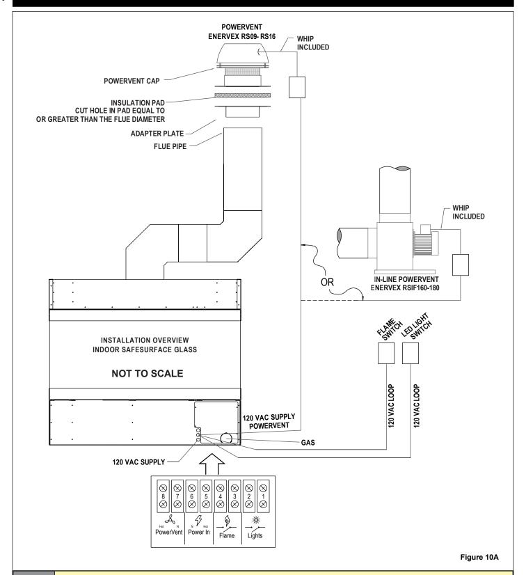
NOTE FOR THE ELECTRICIAN: FIELD WIRING SHOULD BE LABELED FOR EASY IDENTIFICATION.
