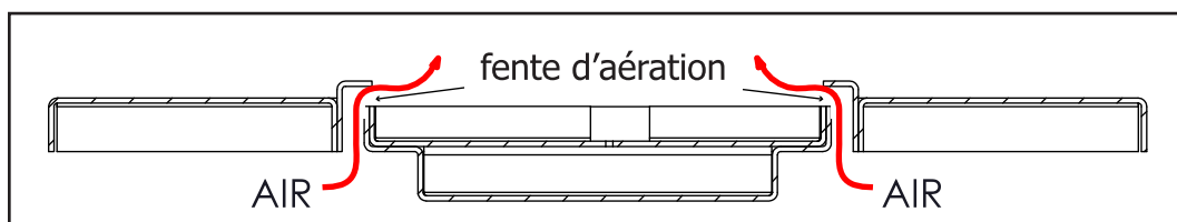
Figure 69: section transversale côté brûleur
