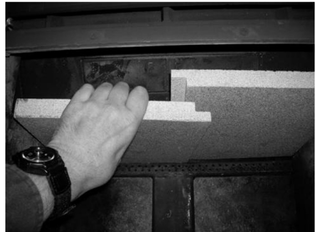
Figure 16 – Enlèvement/Remplacement du Déflecteur pour Inspection
