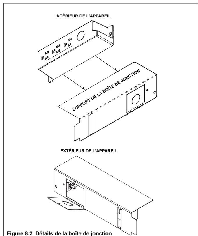
Figure 8.2 Détails de la boîte de jonction
