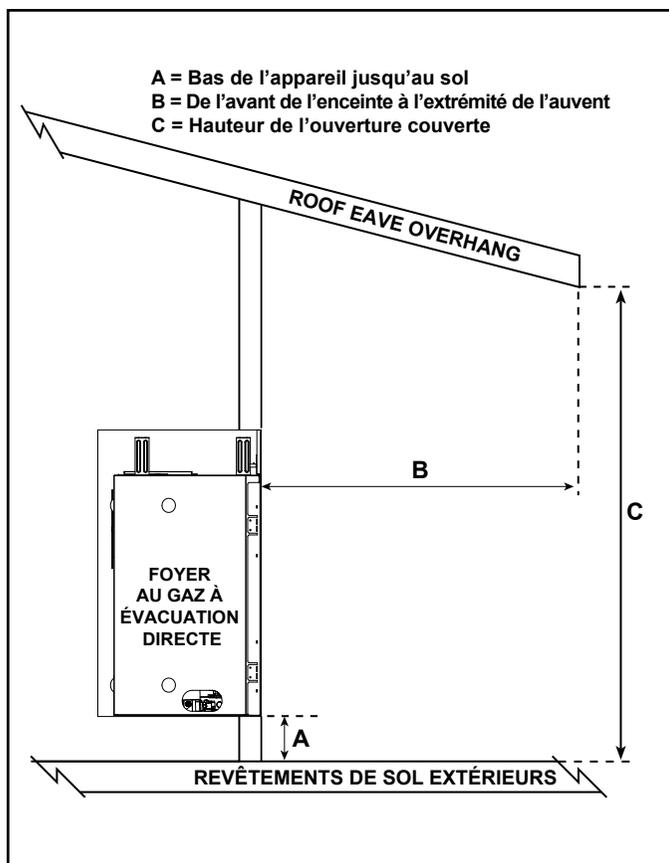
Figure 3.9 Applications extérieures protégées - Dimensions
