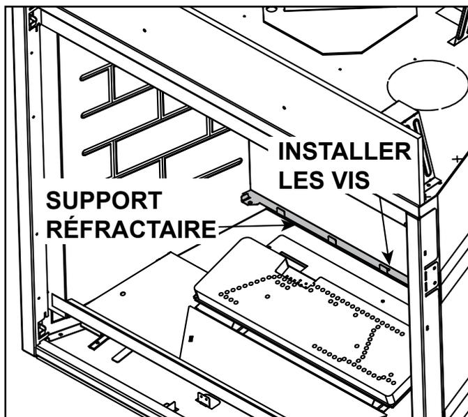
Figure 11.13 Support réfractaire arrière installé
