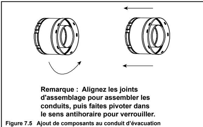
**AVIS :** Lors de l'installation d'un système de conduit d'évacuation avec un chapeau de l'extrémité HRC, tous les joints du système doivent être scellés en utilisant un agent d'étanchéité à base de silicone pour hautes températures (degré minimum d'exposition continue de 150 °C (300 °F)).
