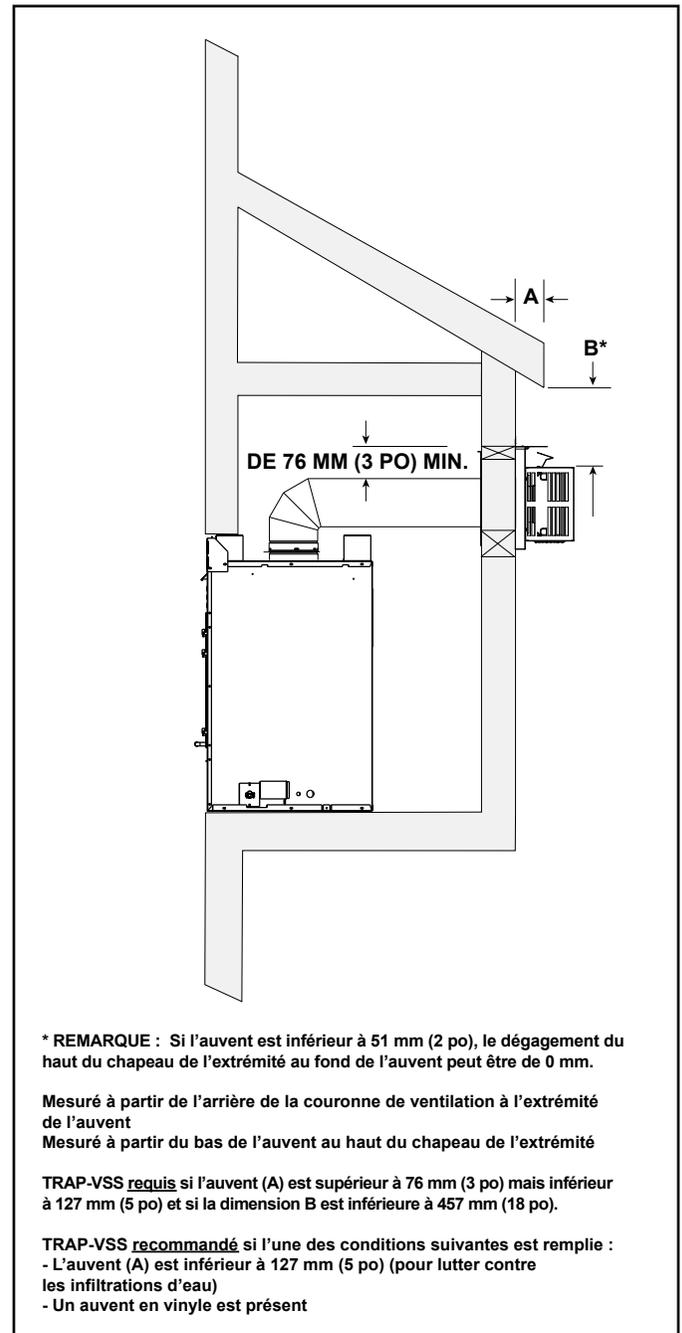
Figure 3.16 Enchâssure extérieure - Exigences minimales de hauteur
