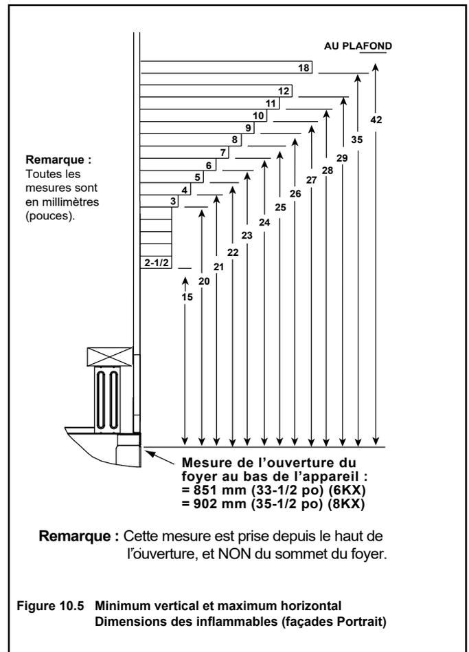
Figure 10.5 Minimum vertical et maximum horizontal Dimensions des inflammables (façades Portrait)
