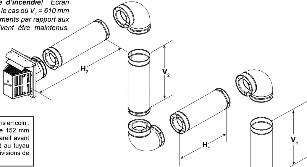
**Remarque :** Pour les installations en coin : Une section de tuyau droit de 152 mm (6 po) peut être fixée à l'appareil avant un coude de 90°, permettant au tuyau d'évacuation de dégager les divisions de sécurité sur l'appareil.
