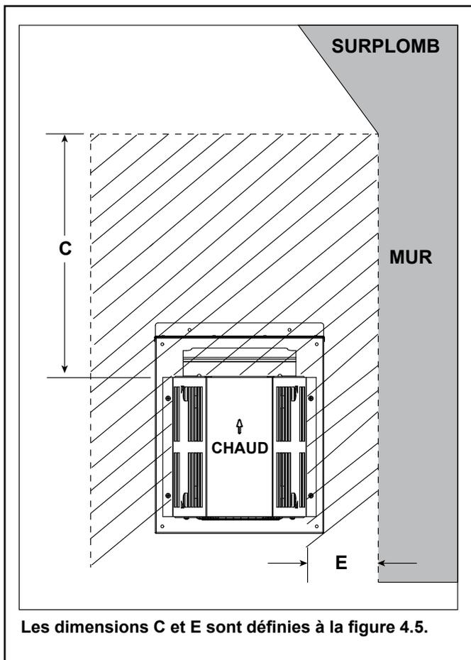
Figure 4.4 Dégagements des extrémités horizontales et verticales
