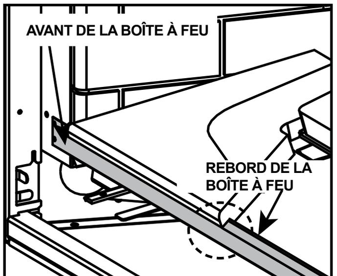
Figure 11.9 Réfractaire de base avant installé
