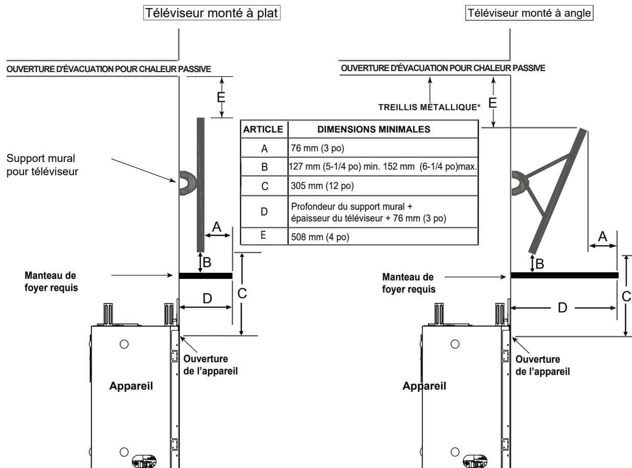
\* L'écran à mailles est requis pour les installations d'évacuation/d'échappement avant ou d'échappement en haut pour la chaleur passive avec une ouverture d'évacuation d'au moins 76 mm (3 po) ou plus.
