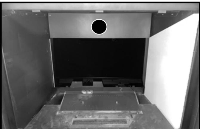
Figure 11.17 Panneau de verre arrière et panneau d'isolation latérale installés
