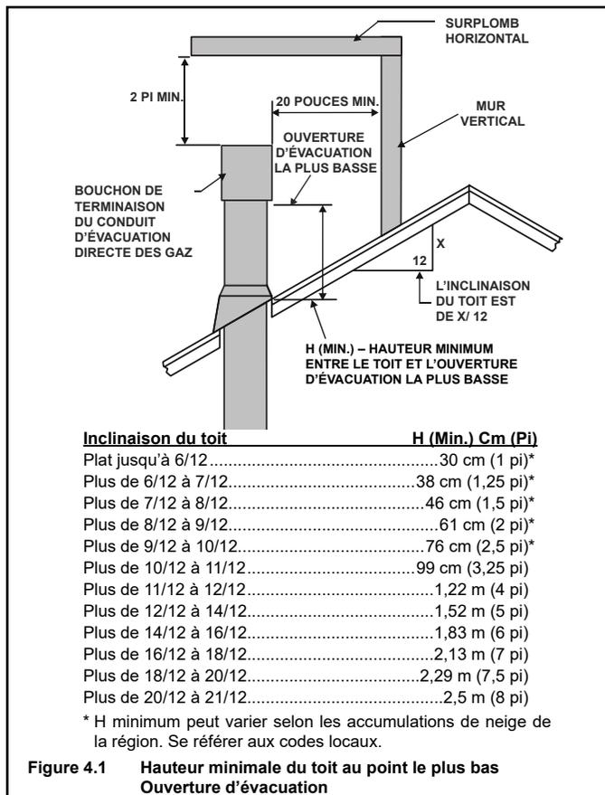
Figure 4.1 Hauteur minimale du toit au point le plus bas
