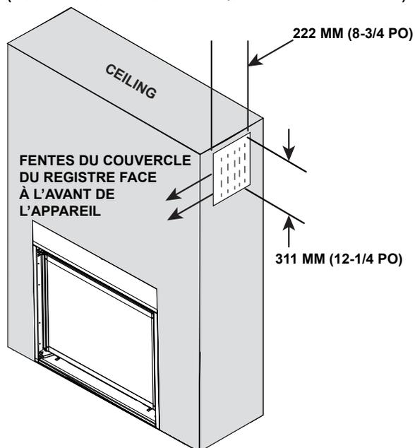
Figure 10.11 Matériau de finition installé avec le système optionnel de gestion de la chaleur passive
