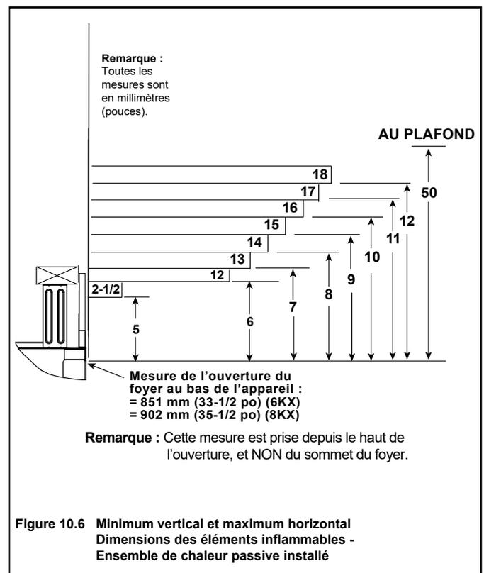
Figure 10.6 Minimum vertical et maximum horizontal Dimensions des éléments inflammables - Ensemble de chaleur passive installé
