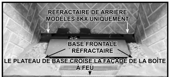
Figure 11.8 Modèles 8KX uniquement : Pièces réfractaires de base installées
