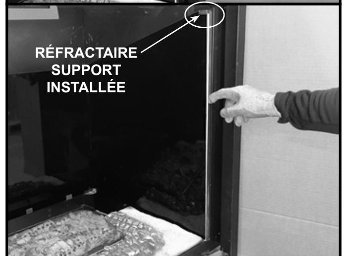
Figure 11.18 Installez le support réfractaire latéral avec le panneau isolant latéral et le panneau de verre latéral
