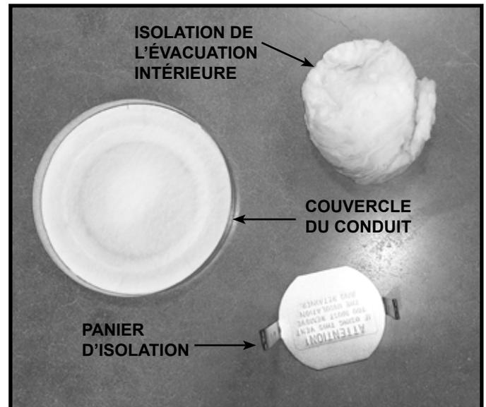
Figure 6.10 Retirez le panier d'isolation et l'isolation de l'évacuation intérieure
