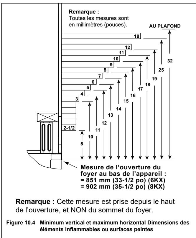
Figure 10.4 Minimum vertical et maximum horizontal Dimensions des éléments inflammables ou surfaces peintes
