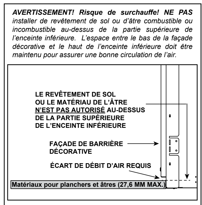
Figure 10.3 Écart de débit d'air requis
