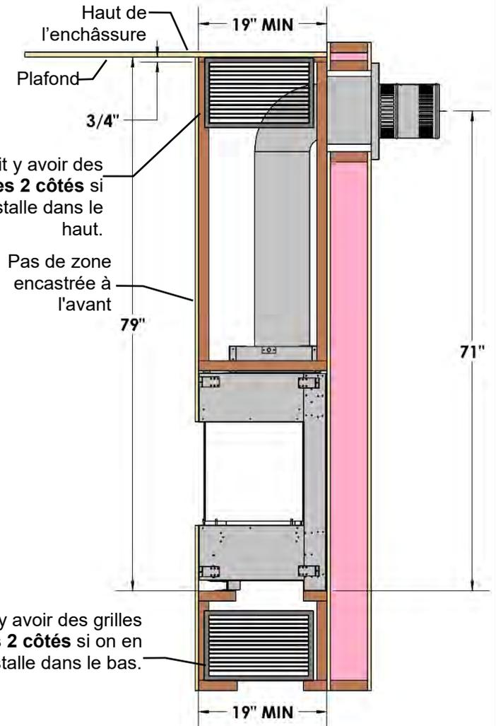
Il doit y avoir des grilles des 2 côtés si on en installe dans le haut.
