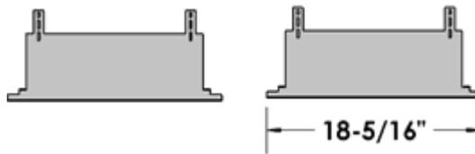
**N.B. :** Installez avant de poser les matériaux de finition. Installez le rebord pour tuile (inclus avec le foyer) en utilisant le 2<sup>e</sup> trou à partir du haut, tel qu'illustré. Ce qui procure le dégagement de 5/8" requis au-dessus de l'ouverture.
