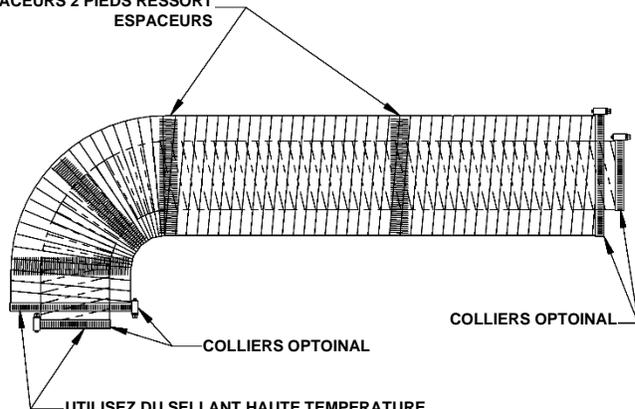
UTILISEZ DU SELLANT HAUTE TEMPERATURE. SECURE AVEC 4 VIS PAR JOINT DU TUYAU.
