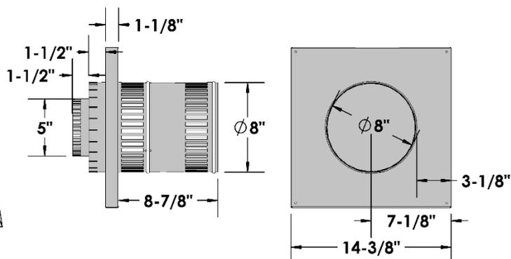
1. Pour déterminer la distance minimale entre le plancher du foyer et le centre de l'évent voir la page Comment encastrer votre foyer. Percez le mur en prévoyant un espace pour un manchon de 12po px12po (diamètre intérieur) pour les murs combustibles et un manchon de 9po de diamètre pour les murs non combustibles. (voir figure 2)
