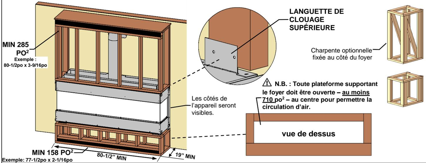
**OPTION C : Charpente fixée à l'arrière du foyer-** Pour les enchâssures en porte-à faux, la charpente doit être autoportante.
