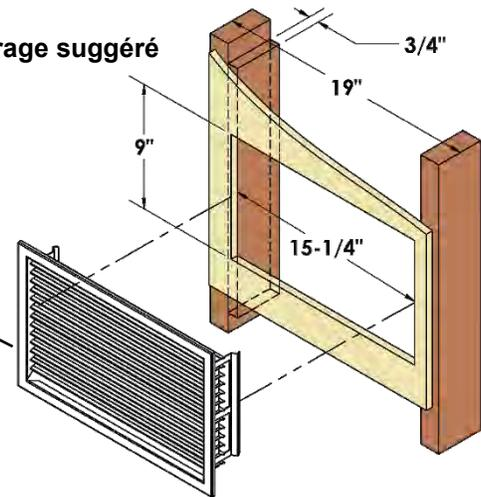
Tient par pression dans l'ouverture de la charpente
