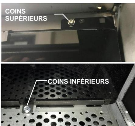
**ÉTAPE QUATRE :** Installez la doublure arrière restante au centre. Fixez avec 2 vis DT dans le haut et 2 dans le bas.
