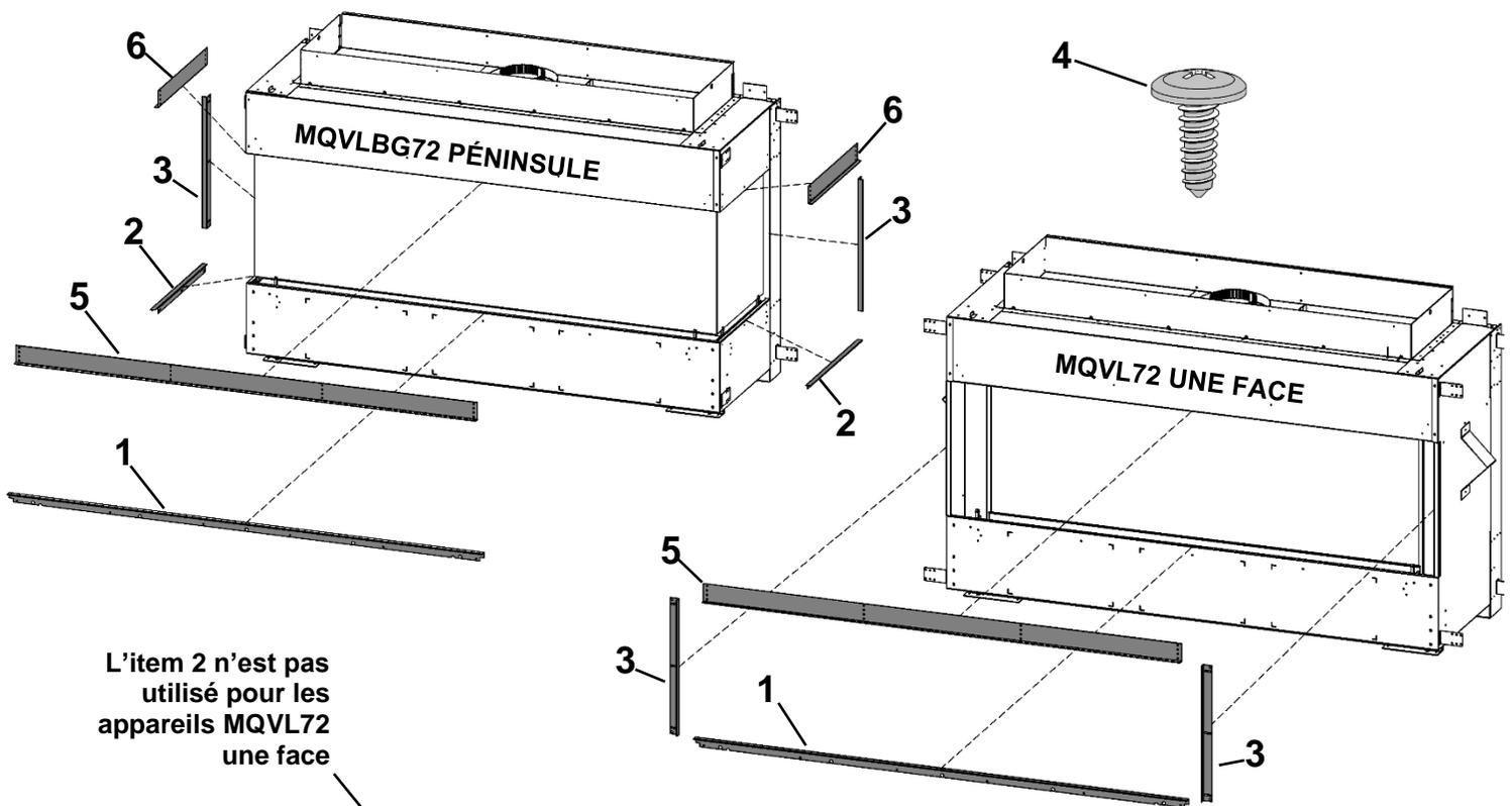
L'item 2 n'est pas utilisé pour les appareils MQVL72 une face
