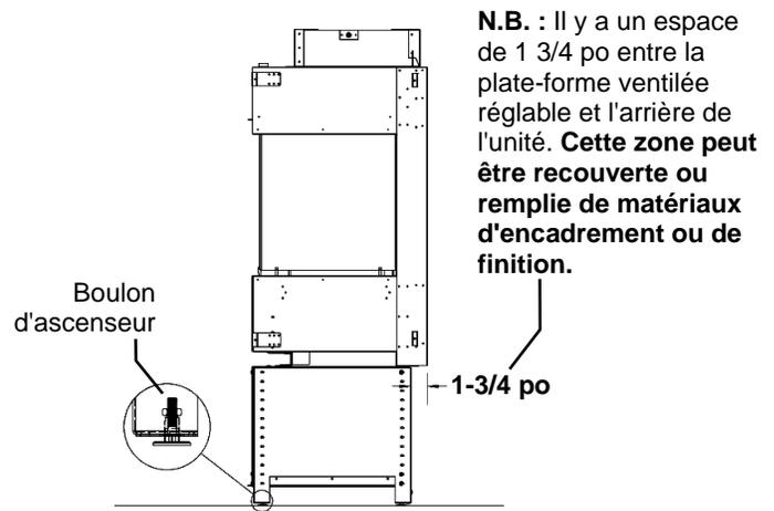
**N.B. :** Il y a un espace de 1 3/4 po entre la plate-forme ventilée réglable et l'arrière de l'unité. Cette zone peut être recouverte ou remplie de matériaux d'encadrement ou de finition.
