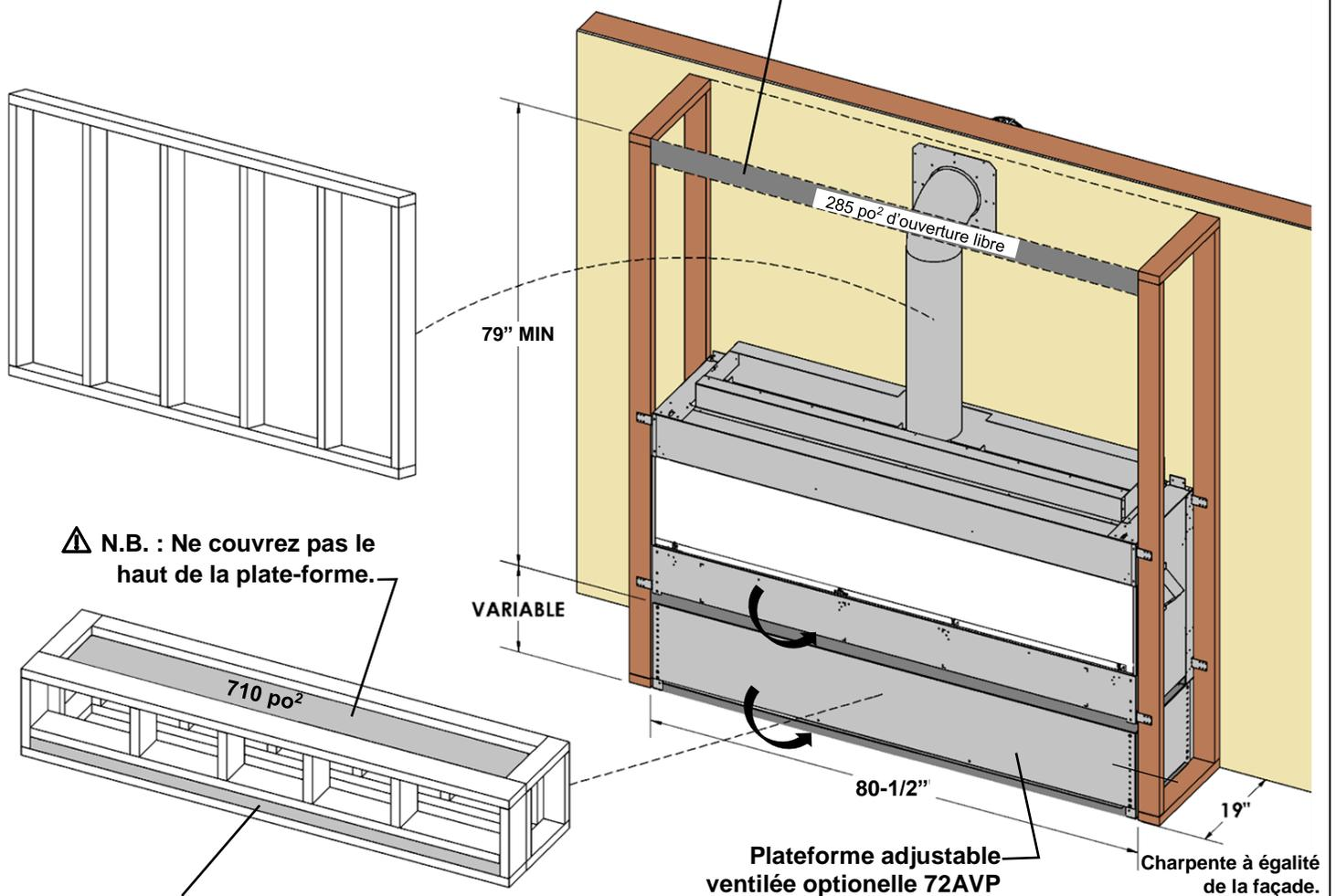
L'enchâssure du foyer **DOIT ÊTRE VENTILÉE** avec ou sans grille. Il doit y avoir **au moins 158 po<sup>2</sup> d'ouverture libre** sous l'appareil.
