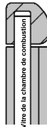
La partie arrondie du joint va vers l'intérieur de la chambre de combustion.
