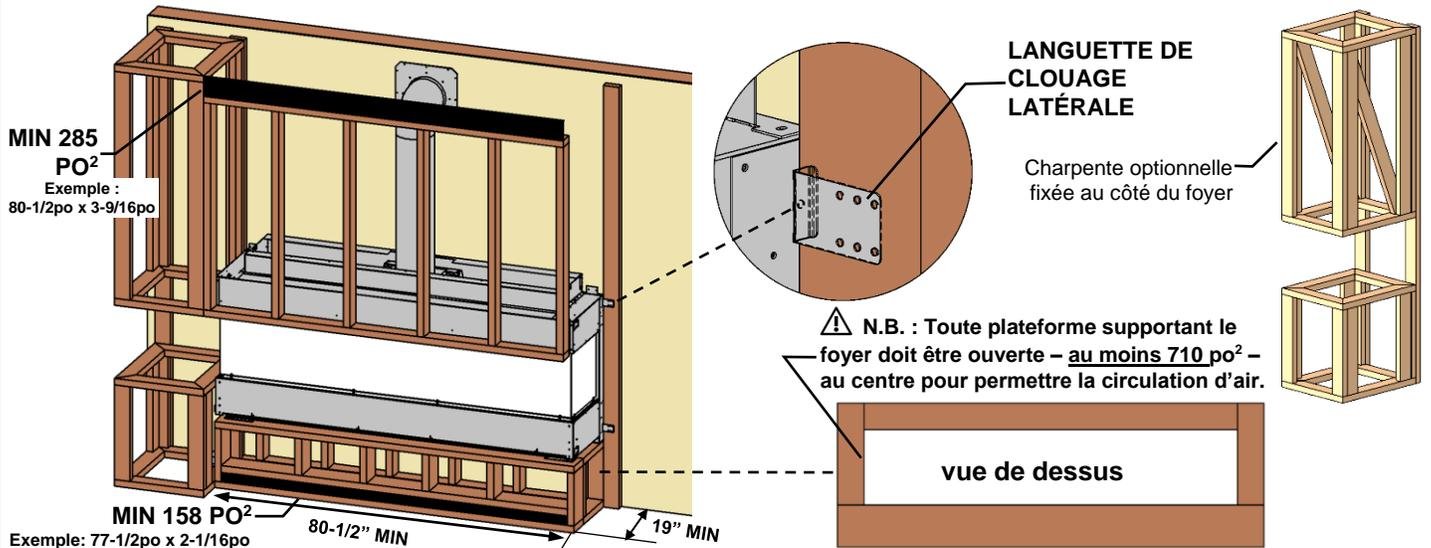
**OPTION B : Charpente fixée au dessus du foyer-** Pour les enchâssures en porte-à faux, la charpente doit être autoportante.
