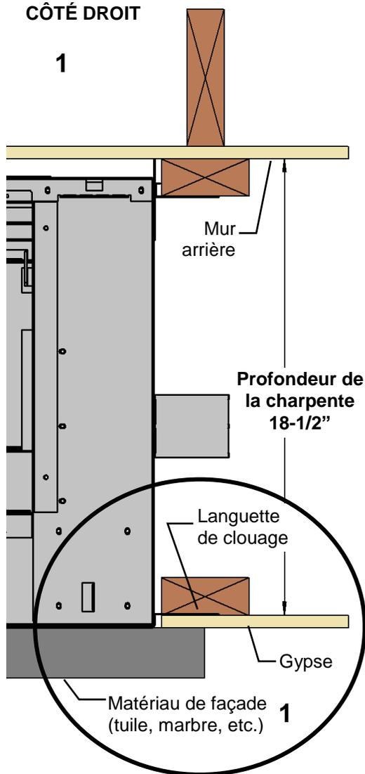
**Charpente à égalité avec le devant du foyer** – La surface du mur fini se rendra jusqu'à l'ouverture du foyer.
