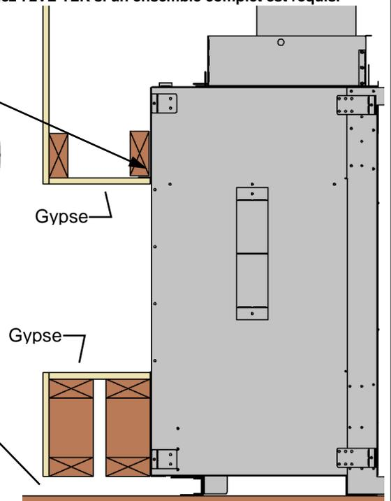
**N.B. :** Avec le VL60S1BL ou l'encadrement SS : installez le rebord en utilisant le 2<sup>e</sup> trou à partir du haut, tel qu'illustré. Ceci procure le dégagement de 5/8" requis au-dessus de l'ouverture.
