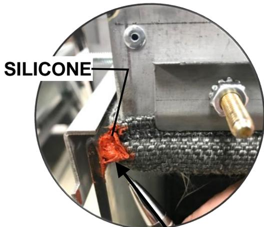
**⚠ IMPORTANT :** Il faut mettre une bille de silicone haute-température à chaque coin entre le joint d'étanchéité et le coin de la vitre. Ceci scellera complètement les coins de la chambre de combustion.
