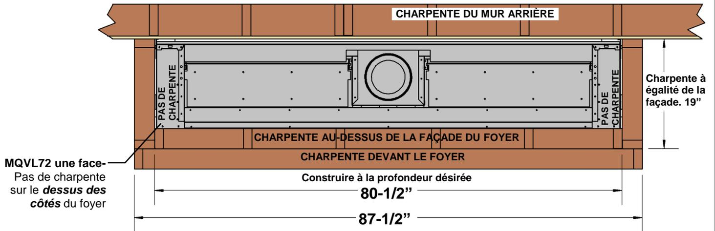
L'appareil doit être en place avec son conduit d'évacuation branché avant que la charpente soit faite au-dessus du foyer.
