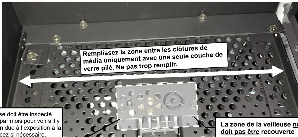
\*L'écran de veilleuse doit être inspecté visuellement une fois par mois pour voir s'il y a signe de détérioration due à l'exposition à la flamme. Remplacez si nécessaire.
