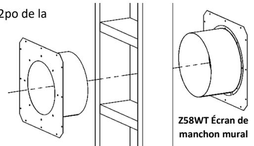
**NB: la sortie de ventilation ne doit pas être encastré dans le mur ou le revêtement extérieur.**
