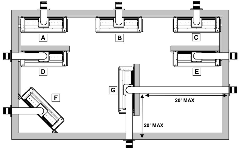
\* Une installation en îlot avec évacuation sur le dessus est possible seulement si la portion horizontale du conduit d'évacuation n'excède pas 20 pieds (6.1m)
