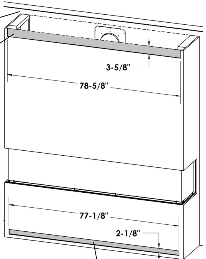
Fente d'aération inférieure (MIN 158 po<sup>2</sup>) NÉCESSAIRE pour TOUTES les installations.
