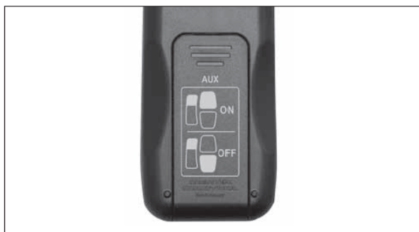
Figure 24: Instructions relatives à l'électrovanne (sur le couvercle du compartiment à piles)
