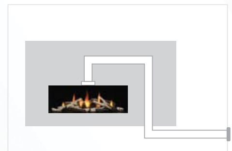
Système d'évacuation forcée horizontale affleurante fin de ligne avec longueur d'évacuation négative
