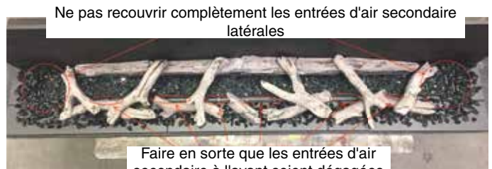
Positionnement correct du charbon noir
