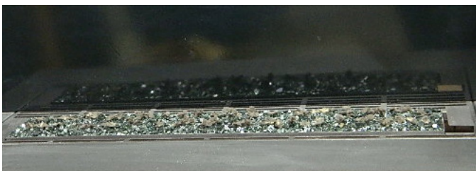
Brûleur recouvert de galets de verre et de laine de roche incandescente
