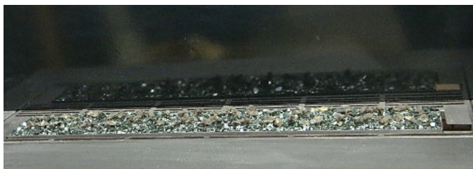
Brûleur recouvert de galets de verre et de laine de roche incandescente
