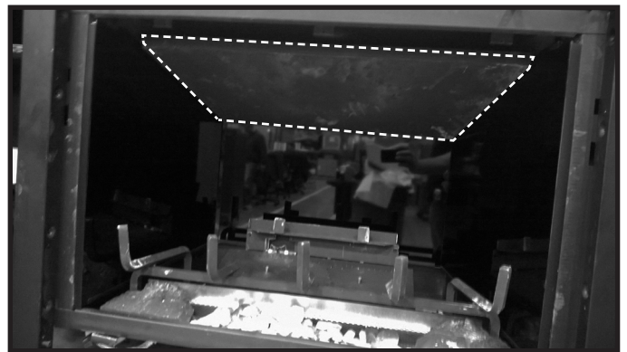
Figure 4. Installer le panneau réfractaire supérieur
