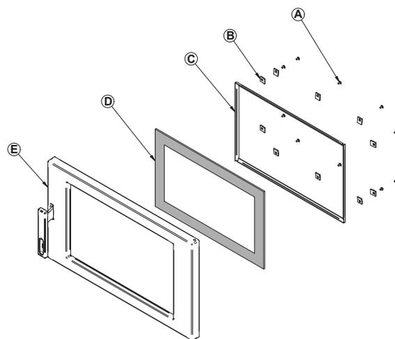
*Les deux principales causes de bris de vitre sont un placement inégal de la vitre dans la porte et un serrage excessif des vis.*
