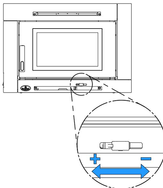
Figure 10: Contrôle de l'admission d'air
