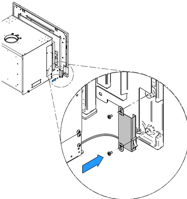
9. Visser la façade sur l'encastable. Attention de ne pas coincer les fils de l'interrupteur.
