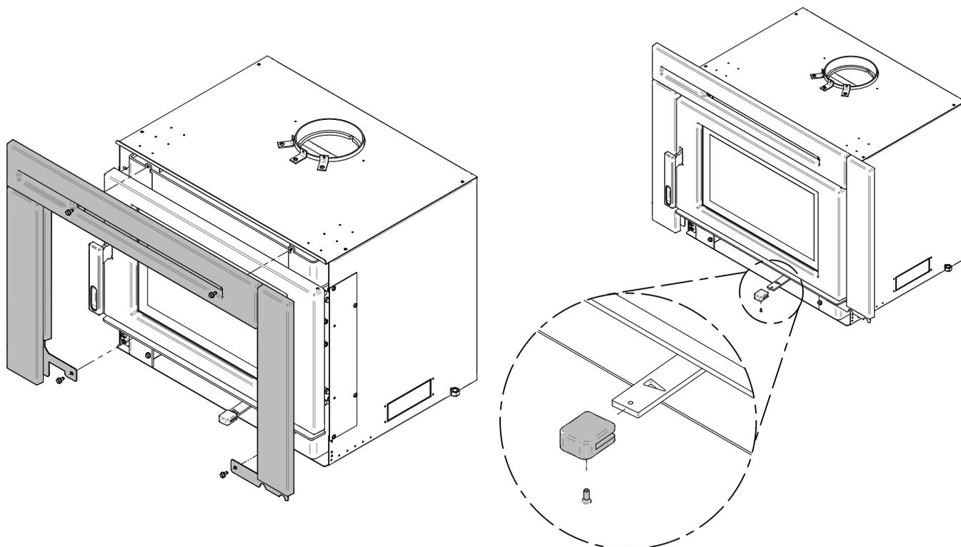
11. Dévisser légèrement les deux vis du bas de l'encastable. Accrocher la façade sur les vis et serrer en place. Réinstaller la poignée de bois.
