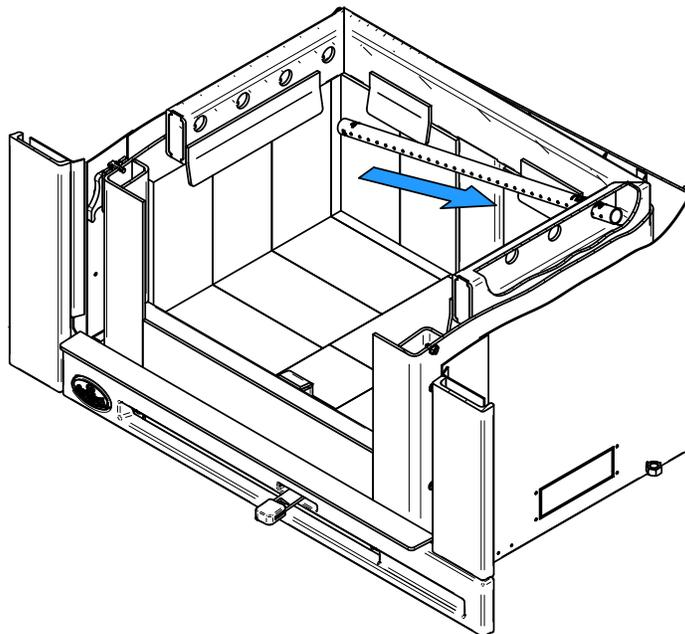
2. Aligner le chemin du tube et la dent dans le trou de la canalisation. Tenir le tube à l'aide d'une pince de serrage et suivre le mouvement décrit dans la figure ci-dessous pour le sécuriser en place. S'assurer que la dent touche le fond du chemin du tube.
