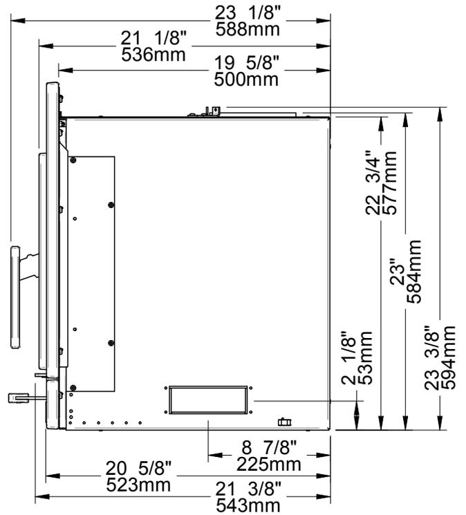
Figure 2: Vue de côté - Projection minimum
