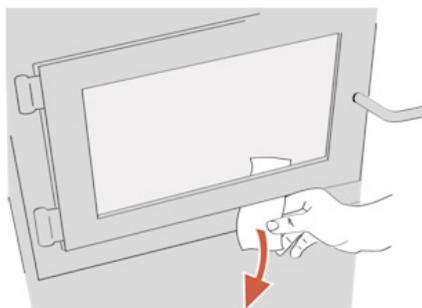
Afin d'obtenir un rendement optimal, la porte doit être parfaitement étanche avec la chambre à combustion. Par conséquent, le joint doit être inspecté périodiquement pour vérifier son étanchéité. L'étanchéité de la porte peut être vérifiée en fermant et en verrouillant la porte sur un bout de papier. Le tour complet de la porte doit être vérifié. Si le papier glisse facilement à n'importe quel endroit, il faut soit ajuster la porte ou remplacer le joint d'étanchéité.
