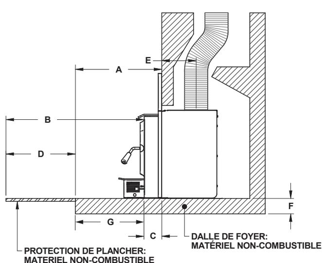
Figure 14: Protection de plancher aditionnelle - Installation non surélevée
