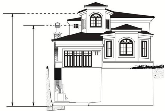
Les cheminées extérieures conduiront à des courants d'air froids lorsqu'il n'y a pas de feu dans l'encastrable, à l'allumage lent des nouveaux feux et au dégagement de fumée lorsque la porte est ouverte pour le chargement.
