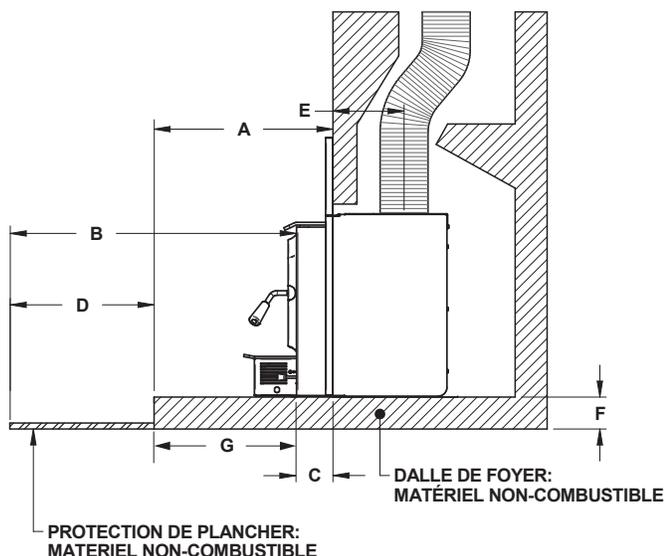
Figure 13: Protection de plancher aditionnelle - Installation surélevée
