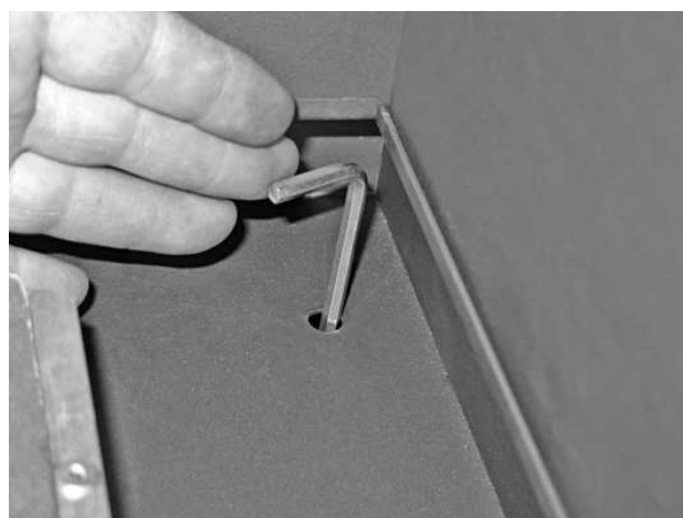
- Réglage de la hauteur avec la clé six pans no. 5.
