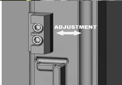
Figure 20 : Ajustement de la butée de porte
