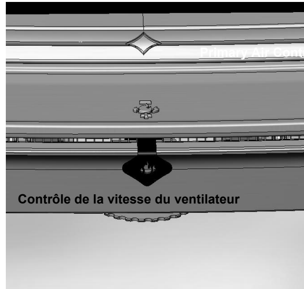
Figure 26 – Commandes d'air primaire et de vitesse du ventilateur
