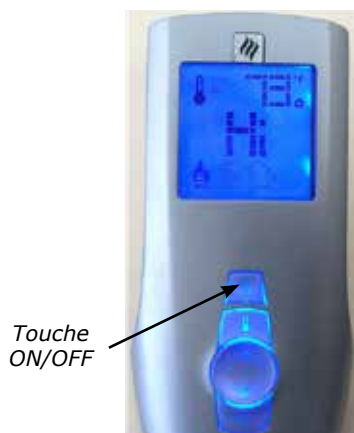
Schéma 2 Télécommande en mode Manuel sur Hi
