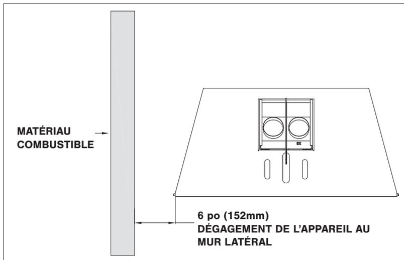
**SI DES MATÉRIAUX COMBUSTIBLES SONT UTILISÉS COMME ÂTRE DEVANT L'APPAREIL, ALORS VOUS DEVEZ UTILISER L'UNE DES DEUX INSTALLATIONS CI-DESSOUS.**
