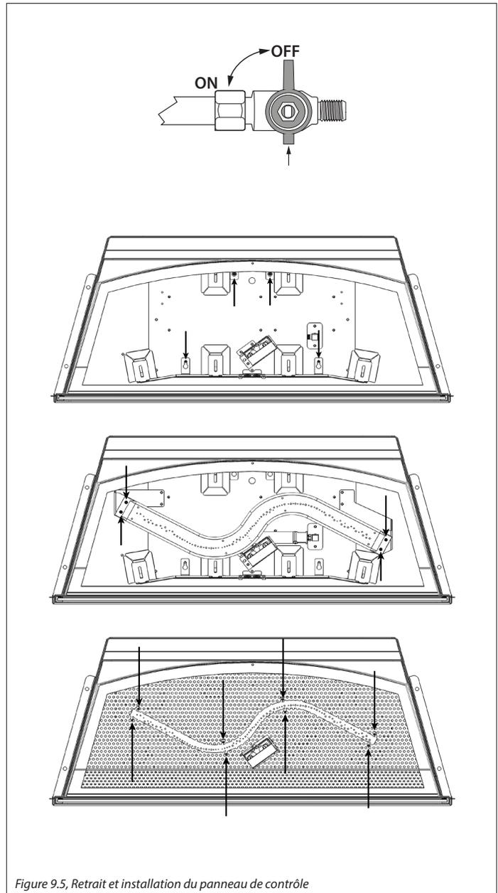
Figure 9.5, Retrait et installation du panneau de contrôle
