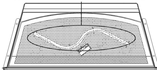
Figure 14.1, Système de brûleur et veilleuse
