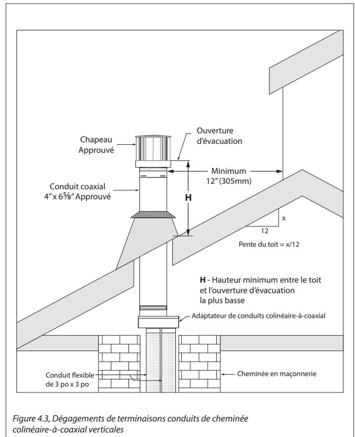
Figure 4.3, Dégagements de terminaisons conduits de cheminée colinéaire-à-coaxial verticales
