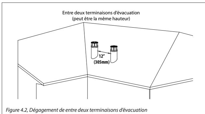
Figure 4.2, Dégagement de entre deux terminaisons d'évacuation
