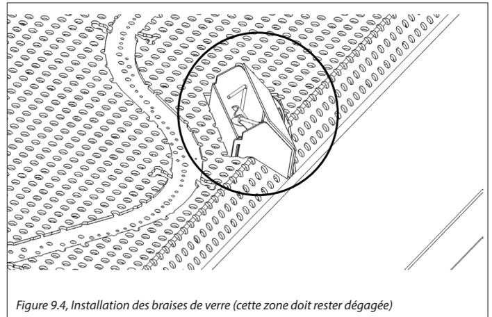
Figure 9.4, Installation des braises de verre (cette zone doit rester dégagée)
