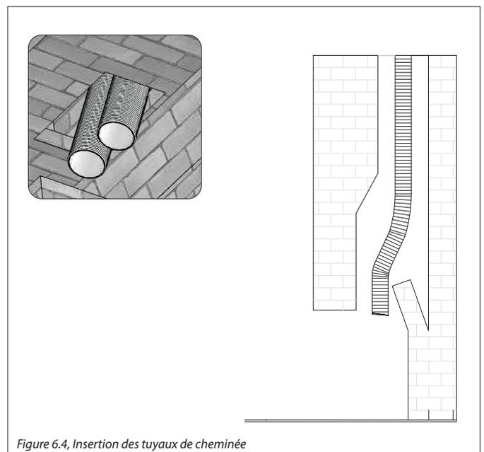
Figure 6.4, Insertion des tuyaux de cheminée
