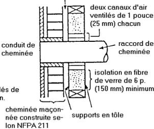
espacement minimum de la cheminée entre la maçonnerie et les supports en tôle et les combustibles de 2 p. (50 mm)
