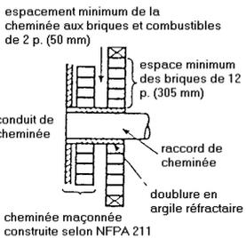
espacement minimum de la cheminée entre la maçonnerie et les supports en tôle et les combustibles de 2 p. (50 mm)
