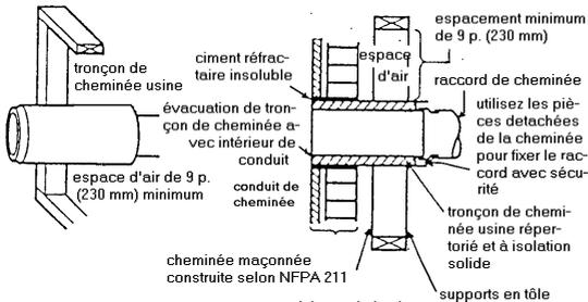
espacement minimum de la cheminée entre la maçonnerie et les supports en tôle et les combustibles de 2 p. (50 mm)
