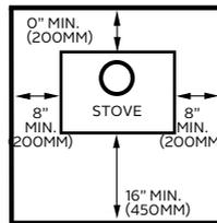
LE PROTÉCTEUR DE PLANCHER DOIT ÊTRE D'UN MATÉRIEL INCOMBUSTIBLE. IL DOIT S'ÉTENDRE EN DESSEUS DE L'APPAREIL ET AU DEVANT, AUX CÔTÉS ET À L'ARRIÈRE DE L'APPAREIL COMME INDICUÉ
